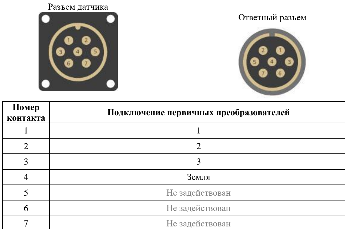
Рис. 2.6 Обозначение контактов разъема для подключения ПП
