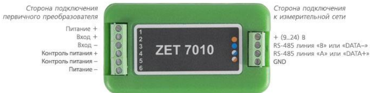
Рис. 2.3 Обозначение контактов ZET 7010 в лабораторном исполнении
