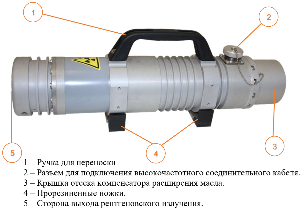
Рисунок 3 – Аппарат «МАРТ-200». Вид с боку
