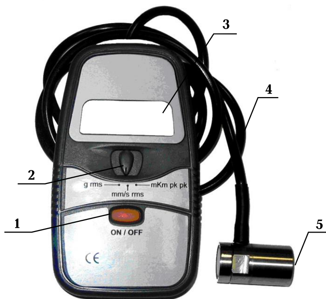
рис. 1 Внешний вид виброметра ВК-5 М.
