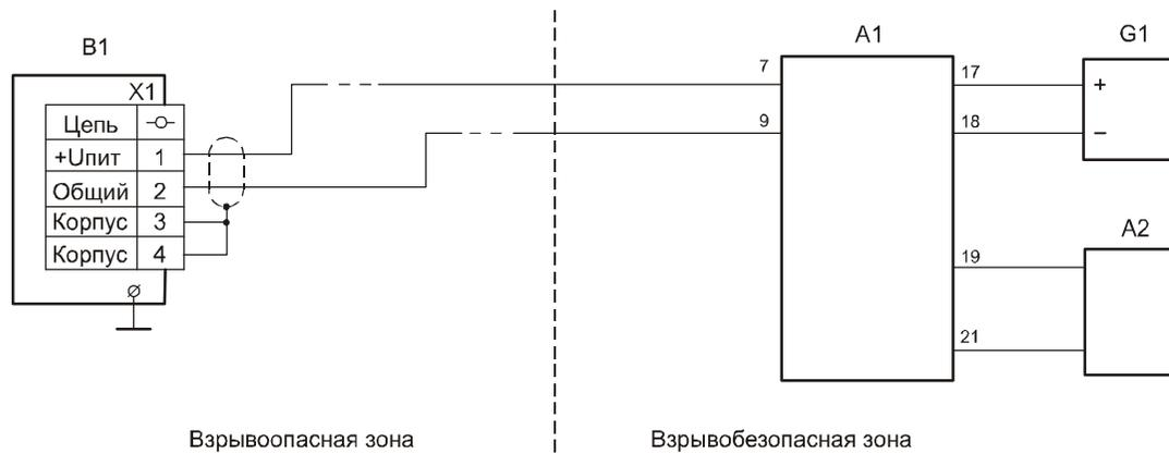
A1 - Ex изолятор (барьер искробезопасности), например БИБ5iH ТУ 4217-057-29421521-09;
