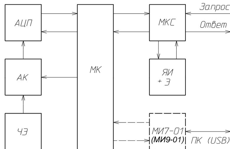
Рисунок 2 - Структурная схема приборов с протоколом АО “Альбатрос”
