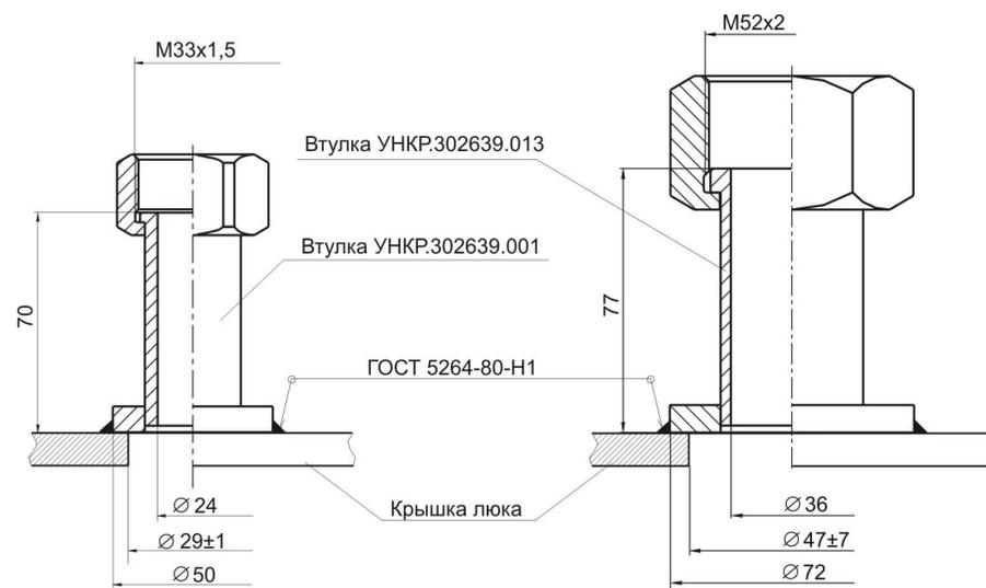
Рисунок 3 - Рекомендуемые посадочные места для установки приборов с использованием втулки (см. приложение А, поле "К")
