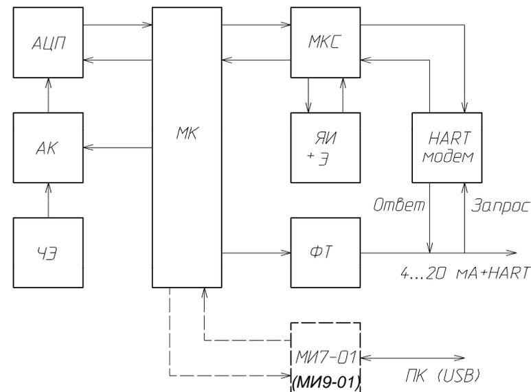
Рисунок 1 - Структурная схема приборов с HART-протоколом
