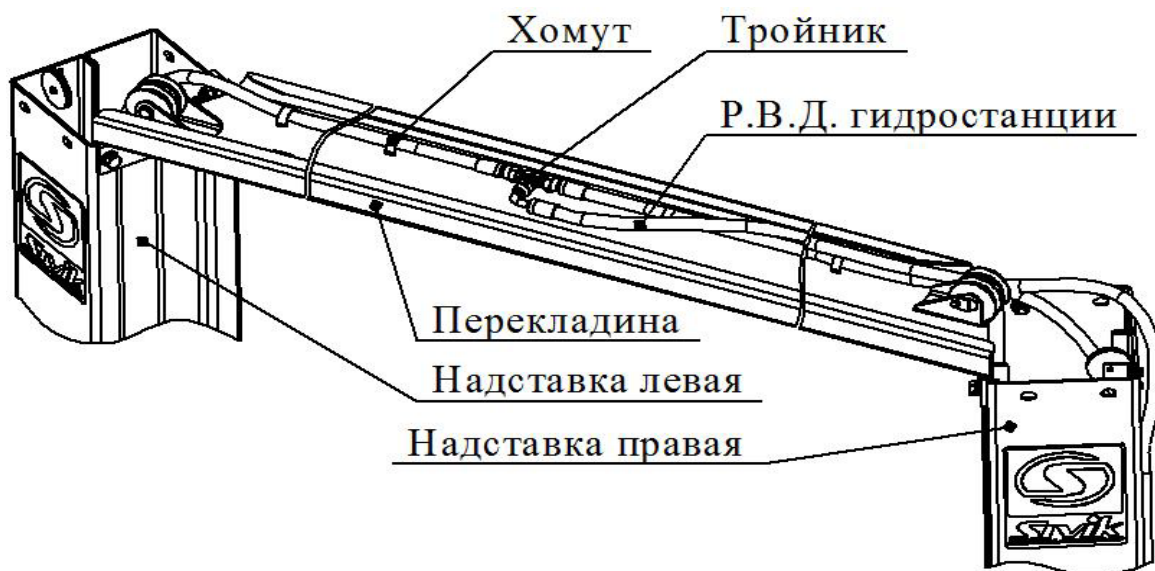
Рисунок 6.4 – Соединение рукава высокого давления
