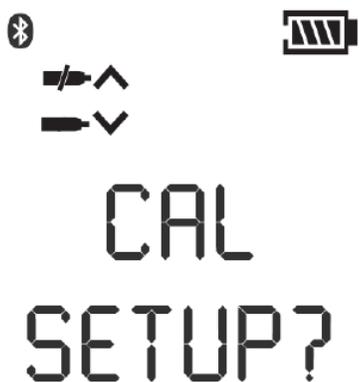
Рисунок 5 Настройка калибровки
