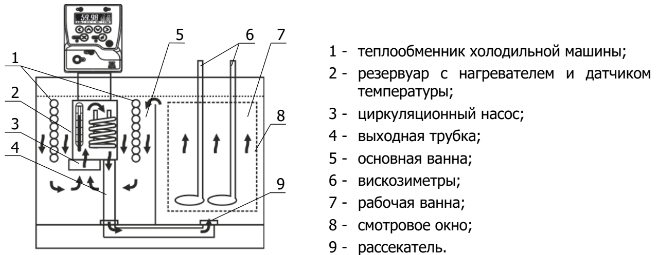
Рисунок 2 — Устройство термостата
