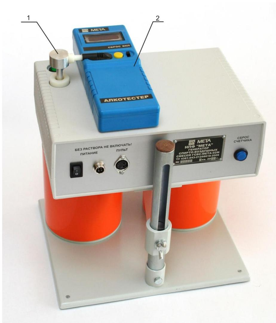
1 – Штуцер выхода ГС генератора; 2 – Индикатор паров этанола в выдыхаемом воздухе «Алкотестер».
