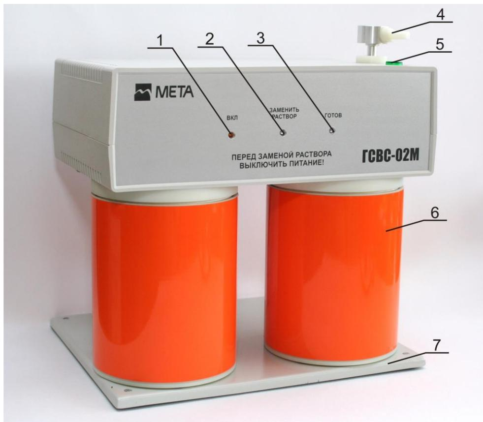
1 – Индикатор включения питания «ВКЛ»; 2 – Индикатор смены раствора «ЗАМЕНИТЬ РАСТВОР»; 3 – Индикатор готовности генератора к работе ГОТОВ; 4 – Штуцер выхода ГС; 5 – Кнопка подачи ГС «СТАРТ»; 6 – Емкость для водного раствора этанола (2 шт.); 7 - Подставка
