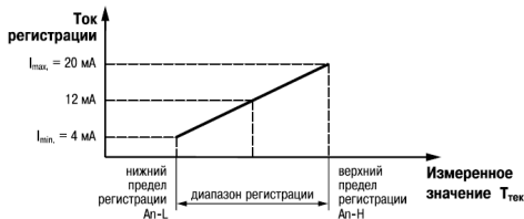
Рисунок 7.6 – Настройка при An-L < An-H
