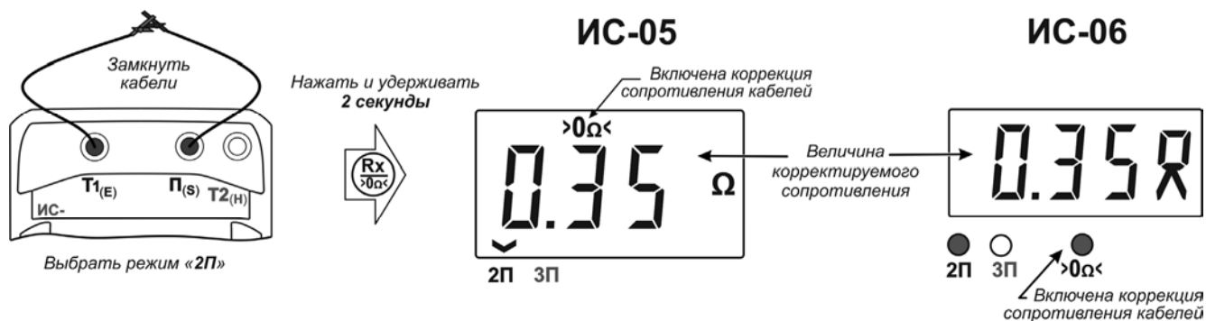
Рисунок 4 – Коррекция сопротивления измерительных кабелей (2П)
