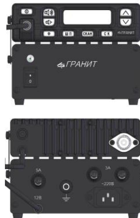
Рисунок 6 - Крепление приемопередатчика на источнике вторичного электропитания
