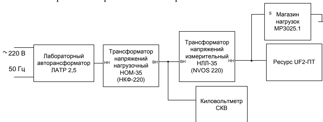
Рисунок 6 – Схема подключения СКВ для проверки действующих значений напряжений переменного тока промышленной частоты
