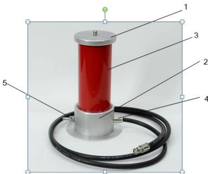
1 - высоковольтный электрод; 2 - основание; 3 - диэлектрический цилиндр; 4 - гнездо приборное; 5 - зажим защитного заземления.
