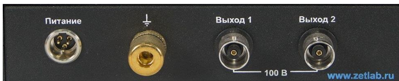
Рис. 4.3 Задняя панель высоковольтного усилителя ZET 420
