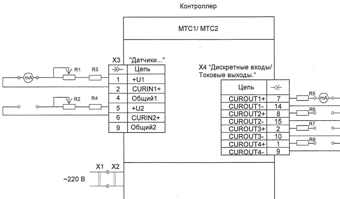
mA – калибратор электрических сигналов UPS-III;
