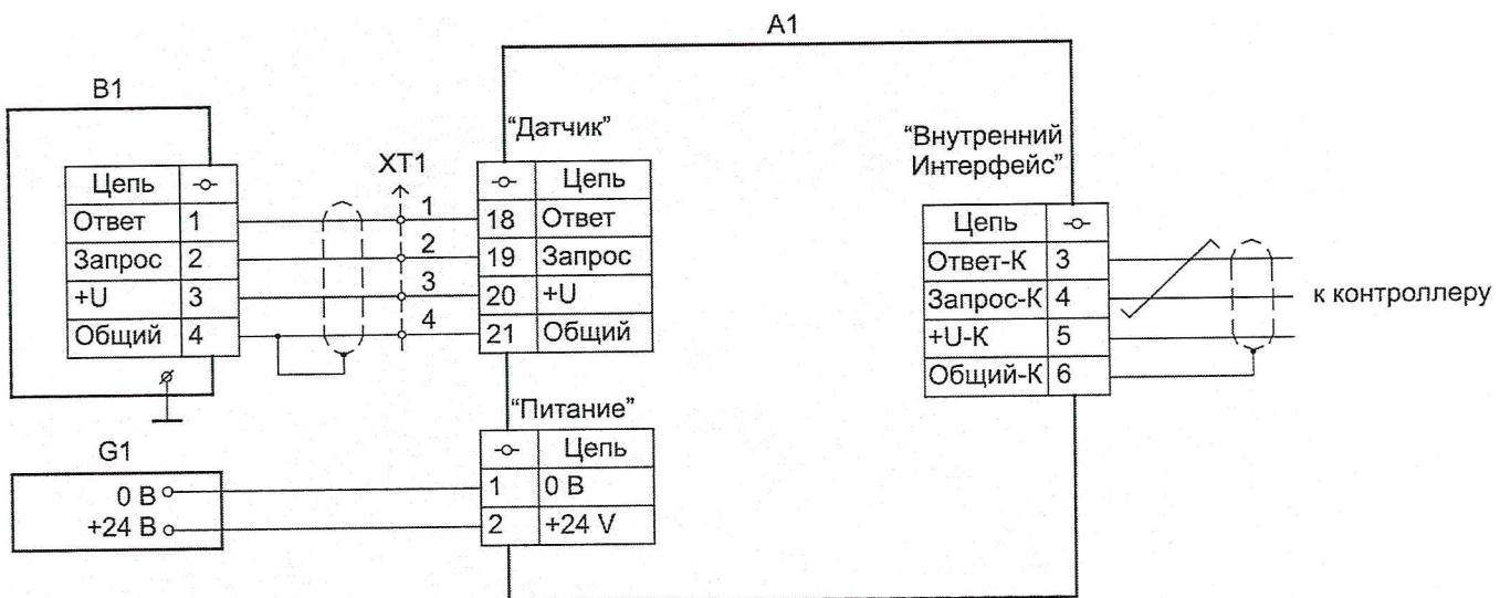
A1 - блок интерфейса искробезопасный БИИ5А;
