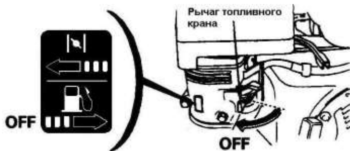
Рисунок 12 – Рычаг топливного крана в положении "OFF" ("Выключено")
