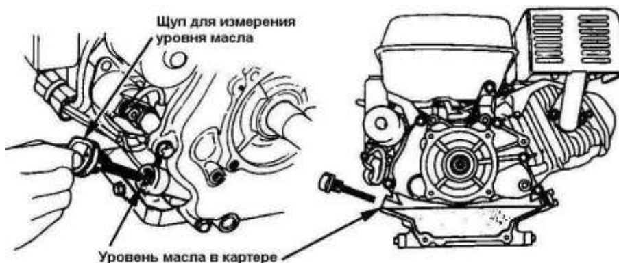
Рисунок 2 – Уровень масла в картере двигателя
