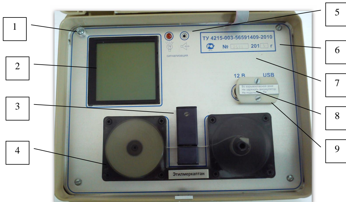
Рисунок 5 – Фальшпанель блока газоанализатора
