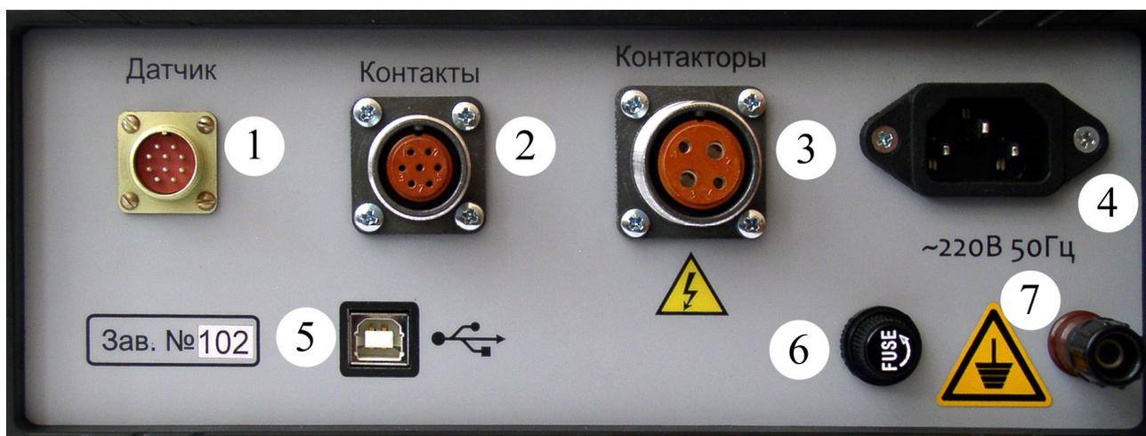
Рис. 2. Задняя панель ТМВ-2
