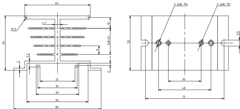
Рисунок 30 – габаритные и установочные размеры радиатора РТР060
