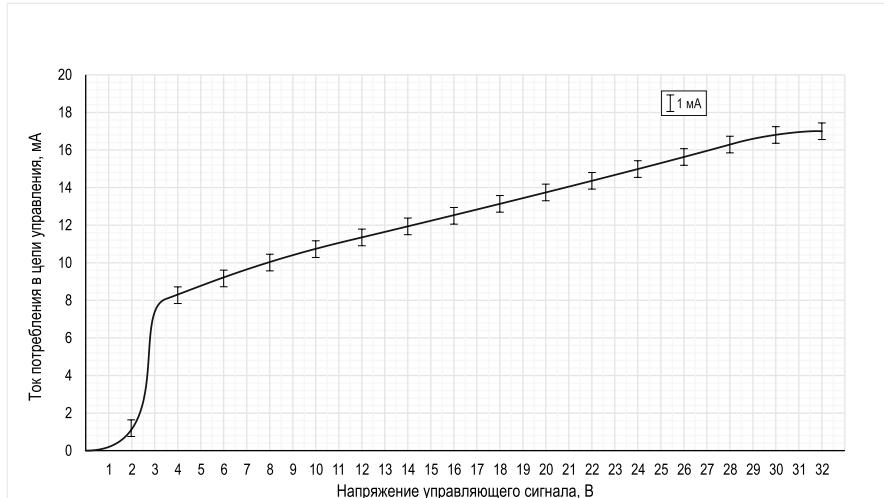
Рисунок 21 - ВАХ входной цепи TTP серии HDH-xx44.ZD3 [M02]
