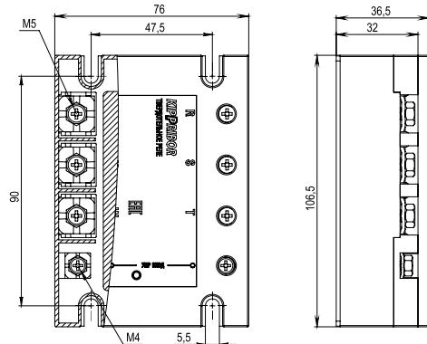
Рисунок 15 - габаритные и установочные размеры TTP серии HT-xx44.ZD3, ZA2 [M02]
