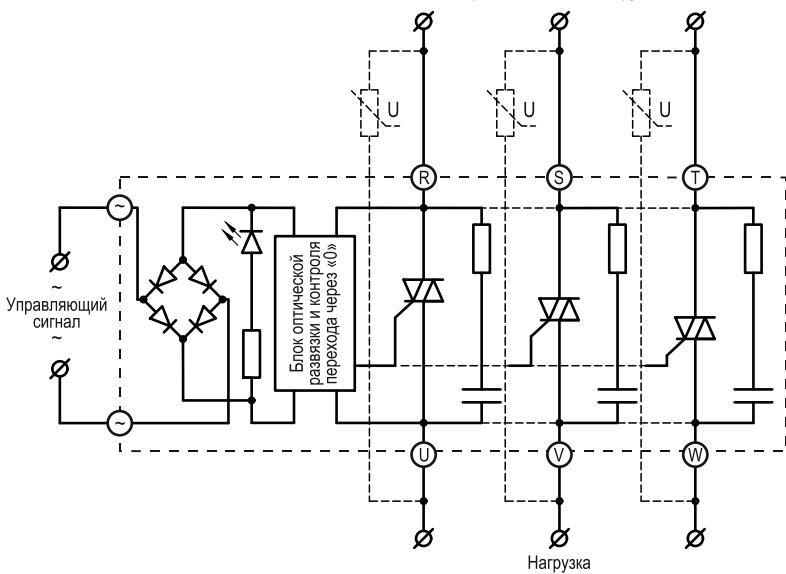
Рисунок 18 – схема подключения TTP серии HT-xx44.ZA2 [M02] с силовыми ключами типа TRIAC.
