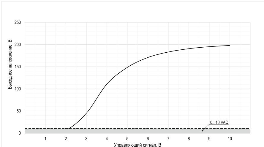
Рисунок 25 - зависимость выходного напряжения от величины управляющего сопротивления TTP серии HD-xx22.10U
