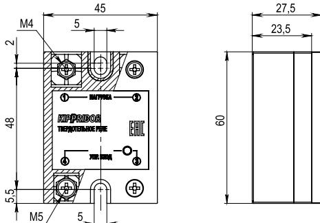
Рисунок 7 - габаритные и установочные размеры TTP серии HD-xx25.DD3 [M02]
