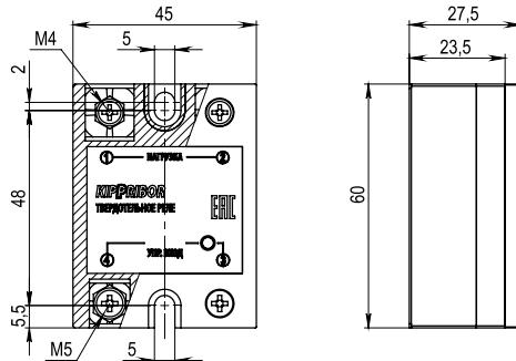
Рисунок 4 - габаритные и установочные размеры TTP серий HD-xx44.ZD3 / ZA2 [M02]
