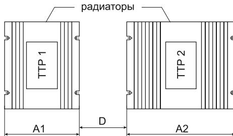
*Рисунок 39 – схема размещения TTP при монтаже в одном ряду*
