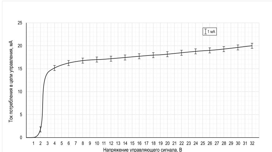
Рисунок 23 - BAX входной цепи TTP серии HT-xx44.ZD3 [M02]
