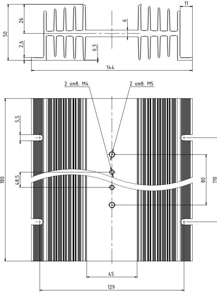
Рисунок 33 – габаритные и установочные размеры радиатора РТР063.1
