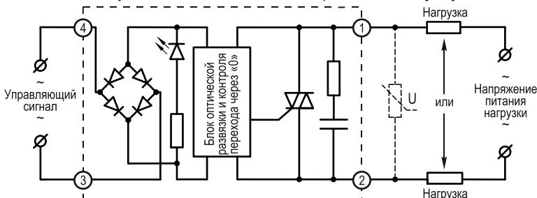
Рисунок 6 - схема подключения TTP серий HD-xx44.ZA2 [M02]
