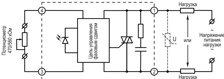
Рисунок 10 - схема подключения TTP серии HD-xx44.VA [M02]
