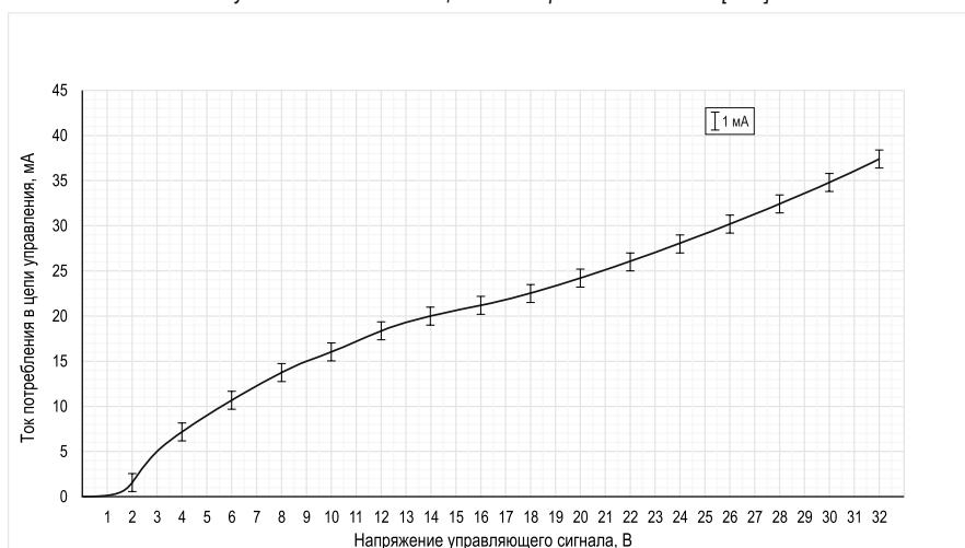
Рисунок 22- ВАХ входной цепи TTP серии HD-xx25.DD3 [M02]
