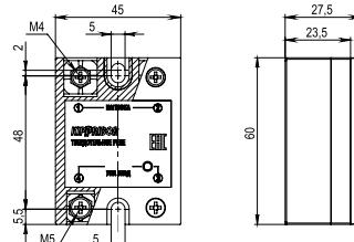
Рисунок 13 - габаритные и установочные размеры TTP серии HDH-xx44.ZD3 [M02]
