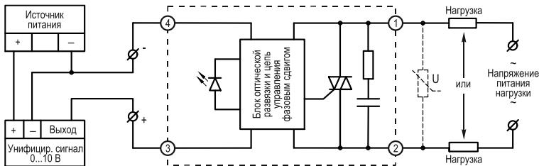
Рисунок 12 - схема подключения TTP серии HD-xx422.10U [M02]
