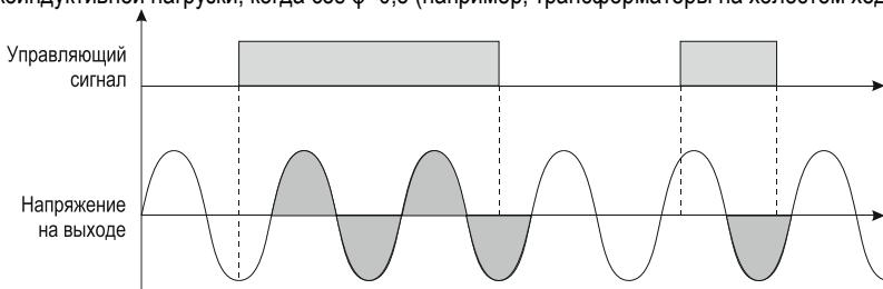
Рисунок 27 – диаграмма срабатывания TTP с контролем перехода через ноль
