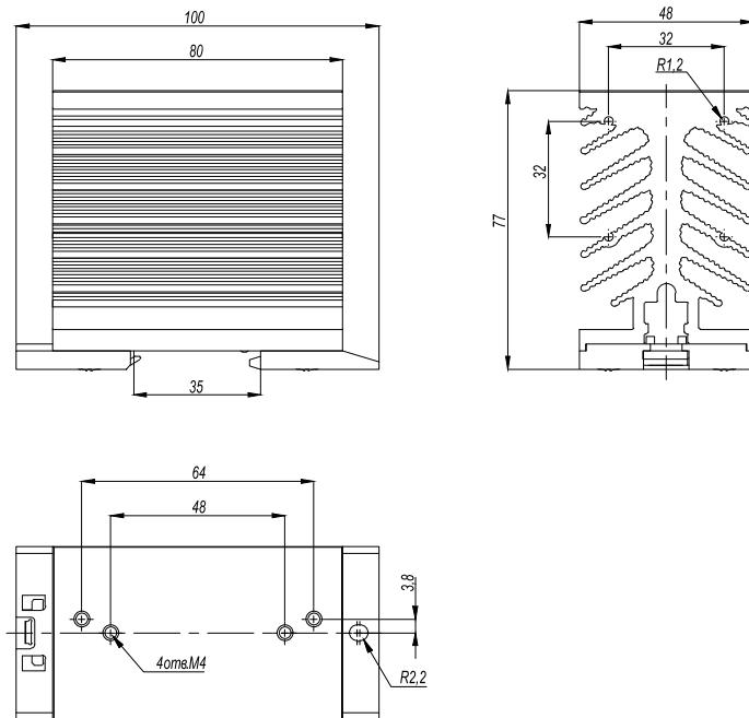
Рисунок 29 – габаритные и установочные размеры радиатора PTP052
