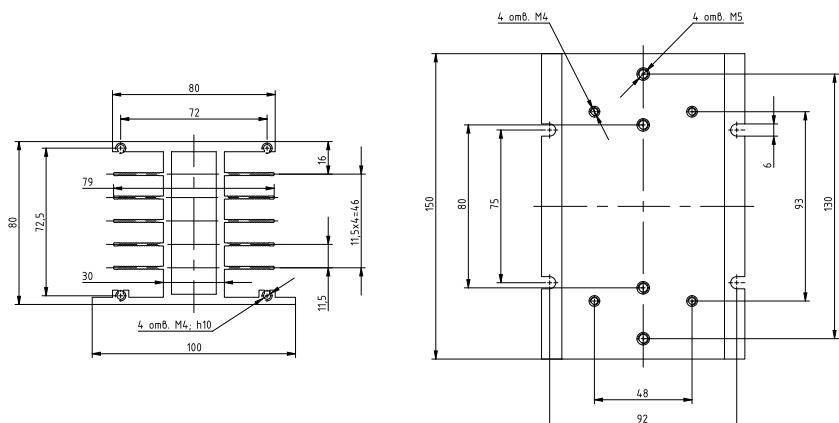
Рисунок 35 – габаритные и установочные размеры радиатора РТР036
