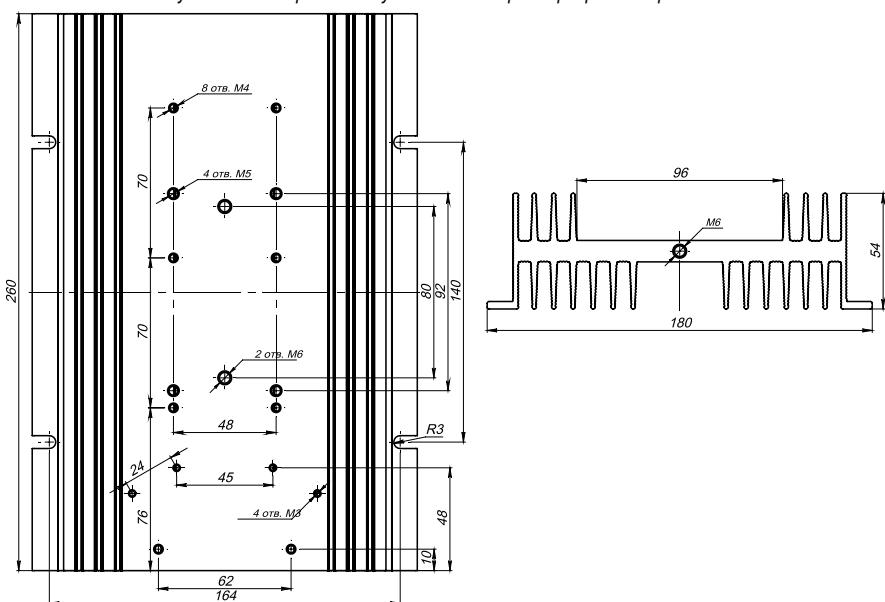
Рисунок 36 – габаритные и установочные размеры радиатора РТР037
