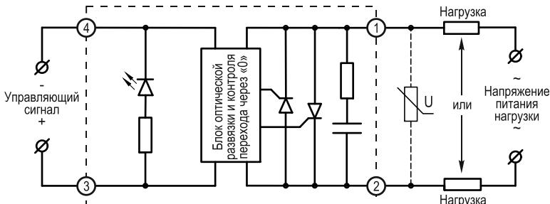
Рисунок 14 - схема подключения TTP серии HDH-xx44.ZD3 [M02]
