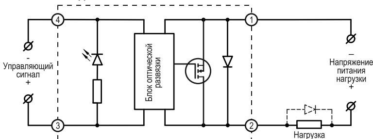
Рисунок 8 - схема подключения TTP серии HD-xx25.DD3 [M02]
