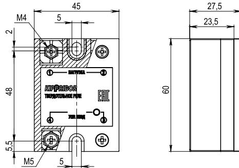
Рисунок 9 - габаритные и установочные размеры TTP серии HD-xx44.VA [M02], HD-xx44.LA [M02], HD-xx22.10U [M02]
