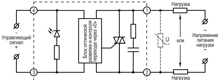
Рисунок 5 – схема подключения TTP серий HD-xx44.ZD3 [M02]
