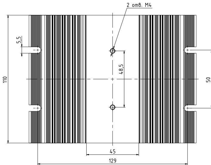
Рисунок 32 – габаритные и установочные размеры радиатора PTP062.1
