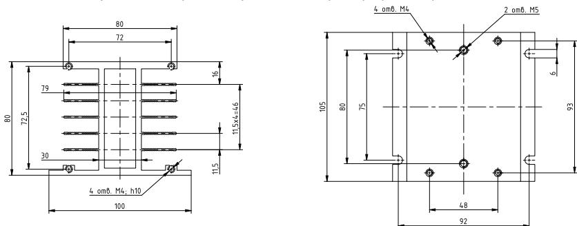
Рисунок 34 – габаритные и установочные размеры радиатора РТР034
