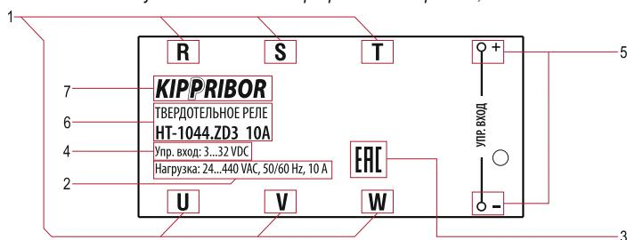
Рисунок 3 - заводская маркировка TTP серии HT
