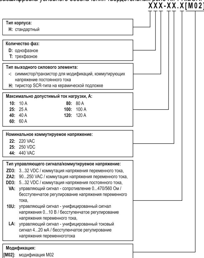
Рисунок 1 - расшифровка условного обозначения TTP KIPPRIBOR модификации [M02].
