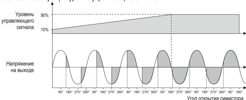
Рисунок 28 – диаграмма срабатывания TTP с фазовым управлением
