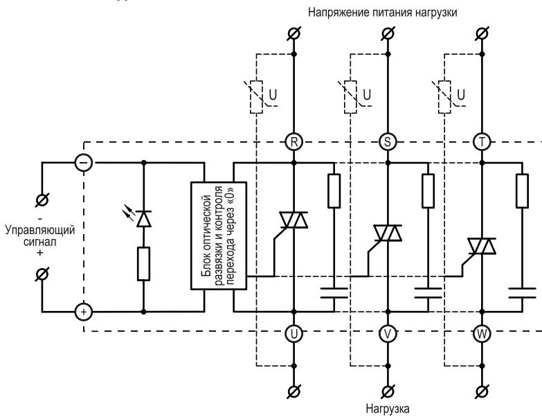
Рисунок 16 – схема подключения TTP серии HT-xx44.ZD3 [M02] с силовыми ключами типа TRIAC
