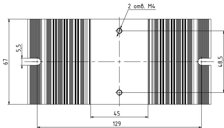
Рисунок 31 – габаритные и установочные размеры радиатора РТР061.1
