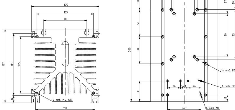
Рисунок 38 – габаритные и установочные размеры радиатора РТР039
