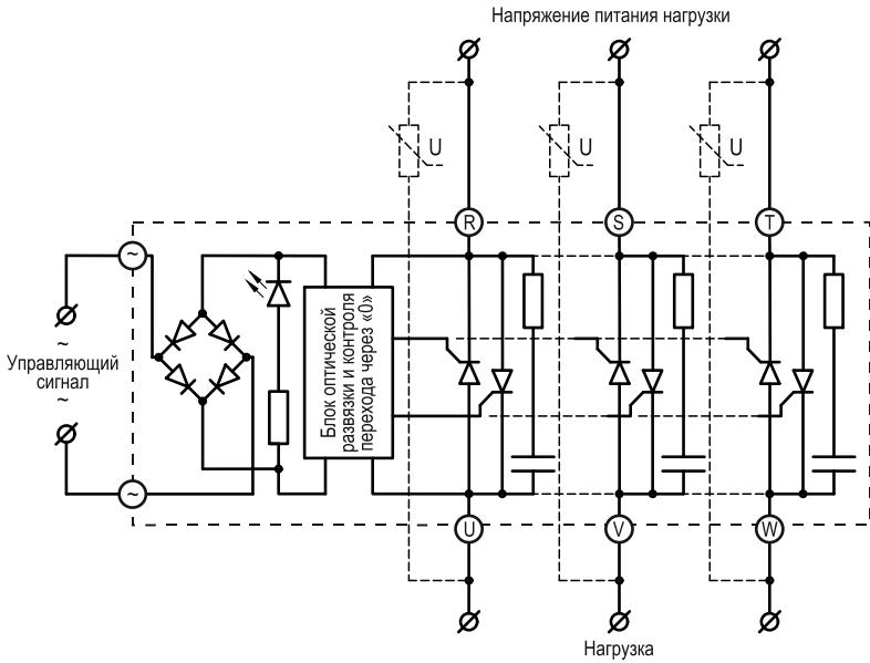
Рисунок 19 – схема подключения TTP серий HT-xx44.ZA2 [M02] с силовыми ключами SCR типа
