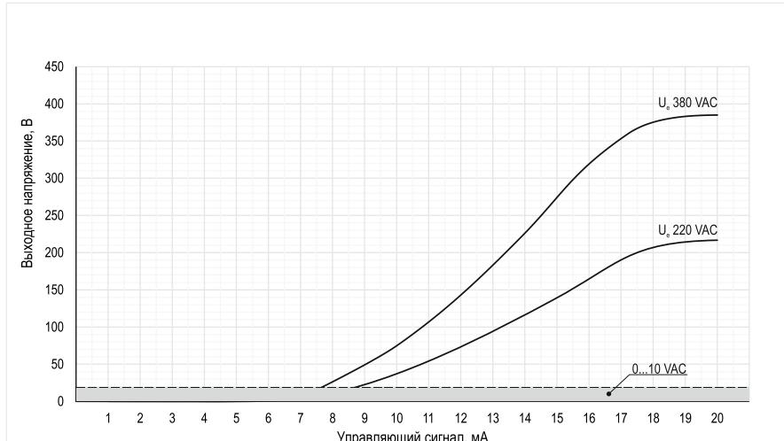
Рисунок 26 - зависимость выходного напряжения от величины управляющего сопротивления TTP серии HD-xx44.LA
