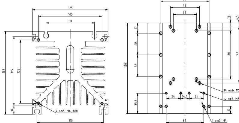
Рисунок 37 – габаритные и установочные размеры радиатора РТР038
