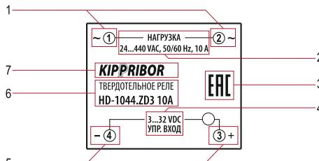
Рисунок 2 – заводская маркировка TTP серий HD, HDH
