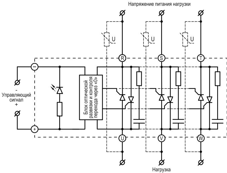
Рисунок 17 – схема подключения TTP серии HT-xx44.ZD3 [M02] с силовыми ключами SCR типа транзистор.
