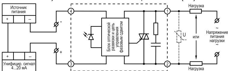
Рисунок 11 - схема подключения TTP серии HD-xx44.LA [M02]
