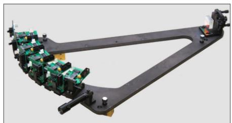
Оптическая система построена по схеме Пашена-Рунге с диаметром круга Роланда 0.5 м. Для обеспечения пространственной стабильности спектра все оптические элементы установлены на единой платформе, имеющей хорошую теплопроводность.
