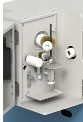
МФС-11 снабжен штативом оригинальной конструкции, который позволяет анализировать различные машинные масла на продукты износа двигателей и других механизмов.
