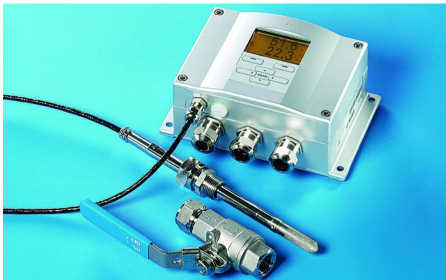
Измерительный преобразователь для монтажа в напорных магистральных и барокамерах, из которых датчик можно удалять, не прерывая работы
