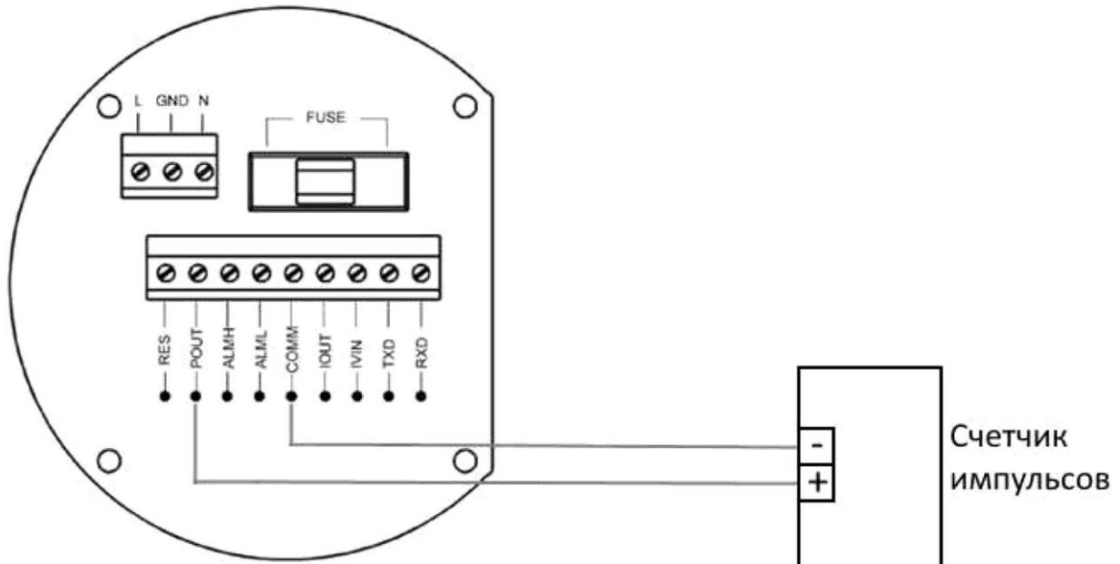
Рисунок 17 - Снятие импульсного или частотного сигнала
