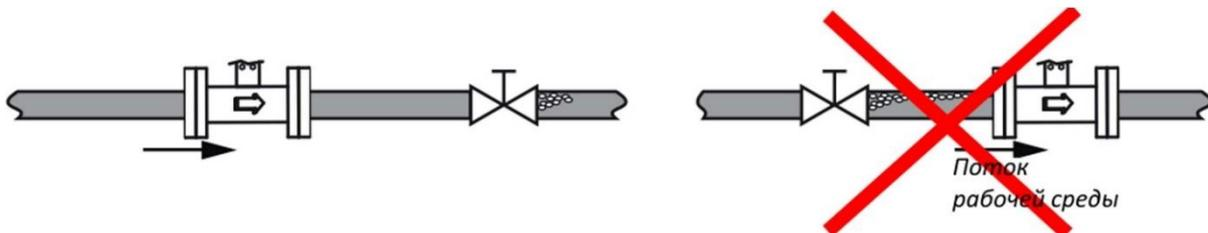
Рисунок 9 - Монтаж расходомера с трубопроводной арматурой
