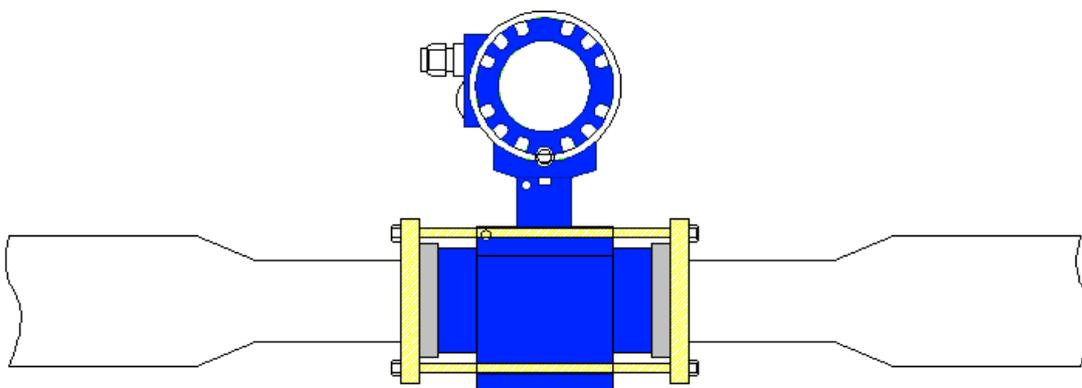
Рисунок 13 – Соединение типа «Сэндвич»
