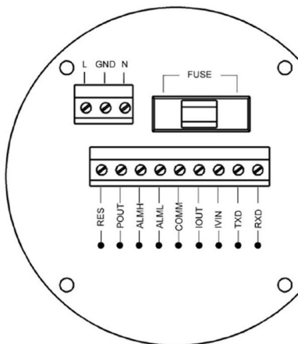
Рисунок 14 – Клеммы электрического подключения вторичного преобразователя
