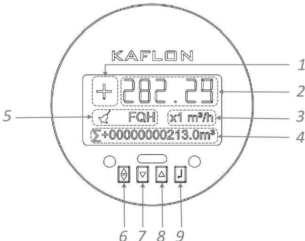
Рисунок 21 – Главный экран расходомера в режиме «Измерение»
