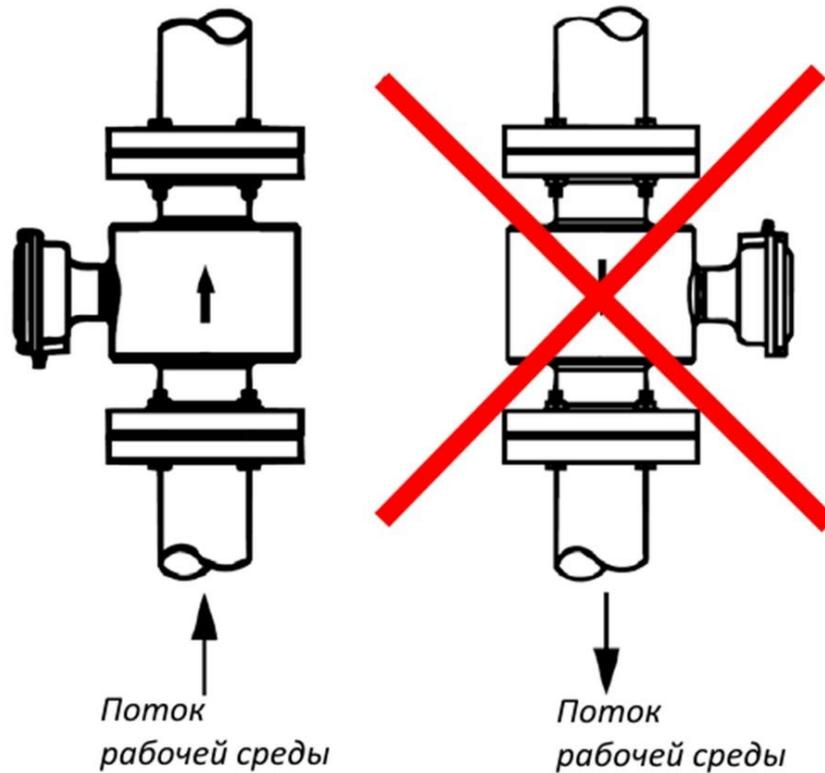
Рисунок 6 - Монтаж на вертикальном трубопроводе
