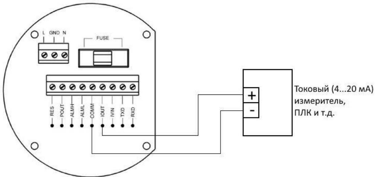
Рисунок 16 - Снятие сигнала 4.. .20 мА
