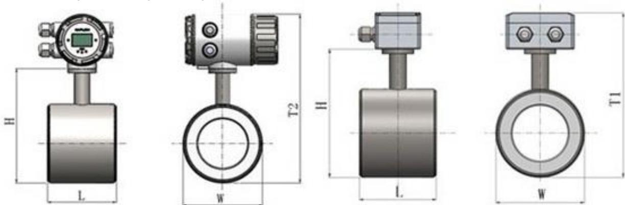
Рисунок 1 - Габаритные размеры расходомера
