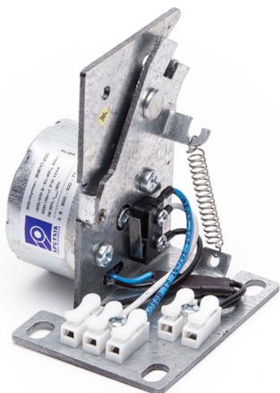
Электромагнитный привод (ЭМП) предназначен для управления клапанами дымоудаления, установленными в системах вентиляции и кондиционирования, и системах противопожарной вентиляции, а также используется в качестве запирающего устройства различных систем.
