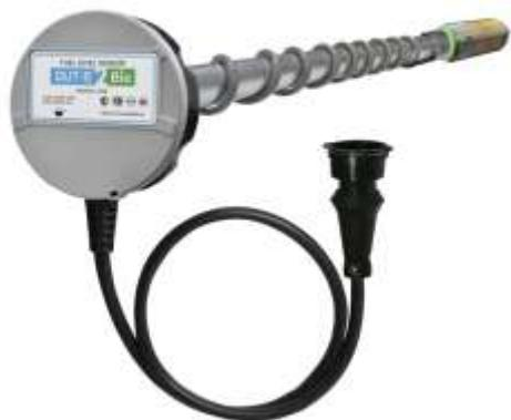
Разные виды топлива (минеральное летнее, минеральное зимнее и, особенно, биотопливо) имеют разный коэффициент диэлектрической проницаемости. Это объясняет разницу в измерении объема топлива с использованием датчиков уровня емкостного принципа. Для учета этой разницы был разработан дифференциальный датчик уровня топлива DUT-E 2Bio.
