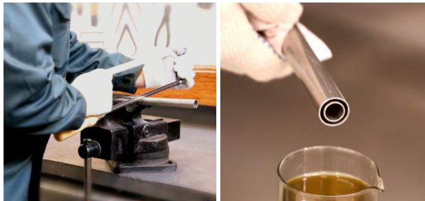
Рисунок 13 — Обрезка измерительной части DUT-E и промывка среза топливом
