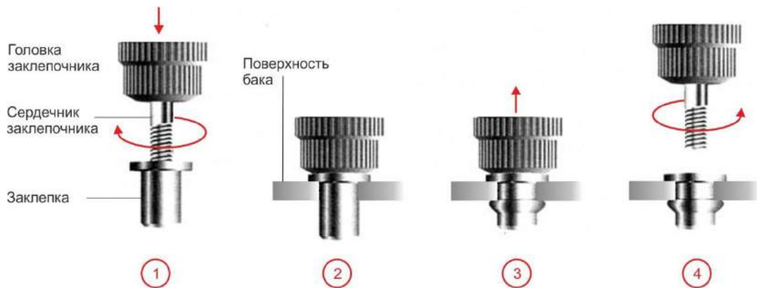
а) порядок установки резьбовых заклепок
