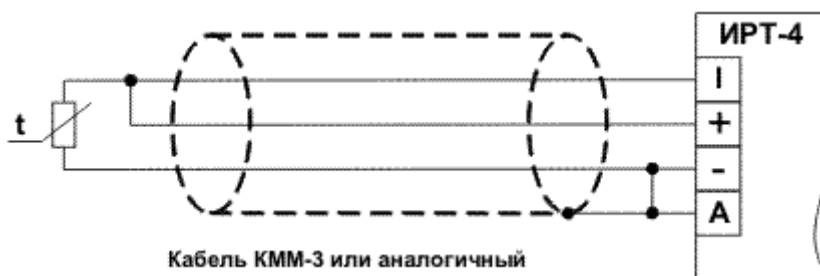
Рисунок 3 Трехпроводная схема подключения ТС
