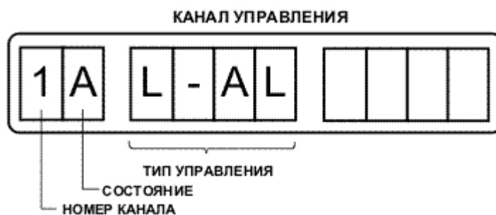
Рисунок 28 Канал управления при контроле состояния объекта
