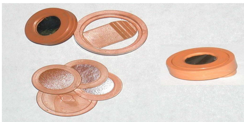
Рисунок 1.2 - Устройство дозиметров типа А
