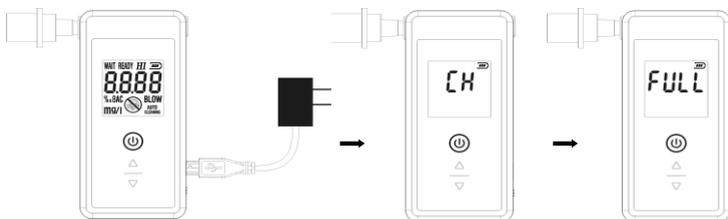
Рисунок 2 – Зарядка аккумулятора
