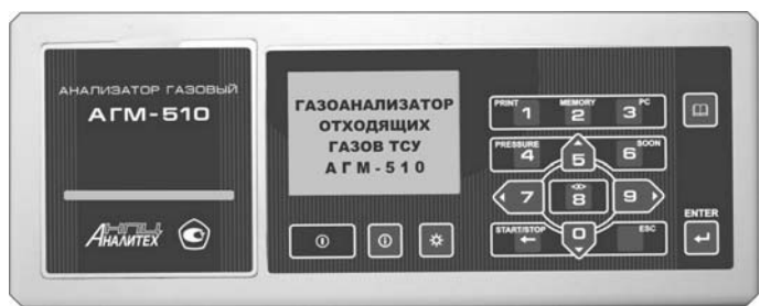
Рис Б.1. Газоанализатор АГМ-510, лицевая панель.
