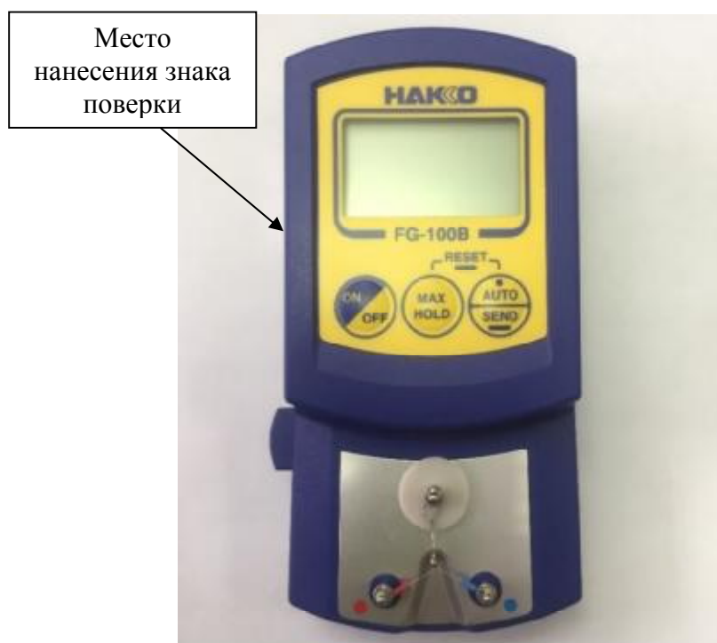
Рисунок 1 – Общий вид термометров с указанием места нанесения знака поверки
