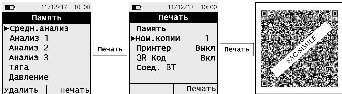
**6. Детальный вид экрана генератора QR-кода, для скачивания отчета по анализам.**
