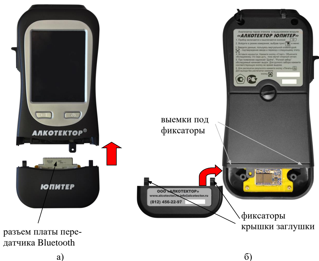
Рисунок 32 – Подсоединение заглушки к основному блоку анализатора
