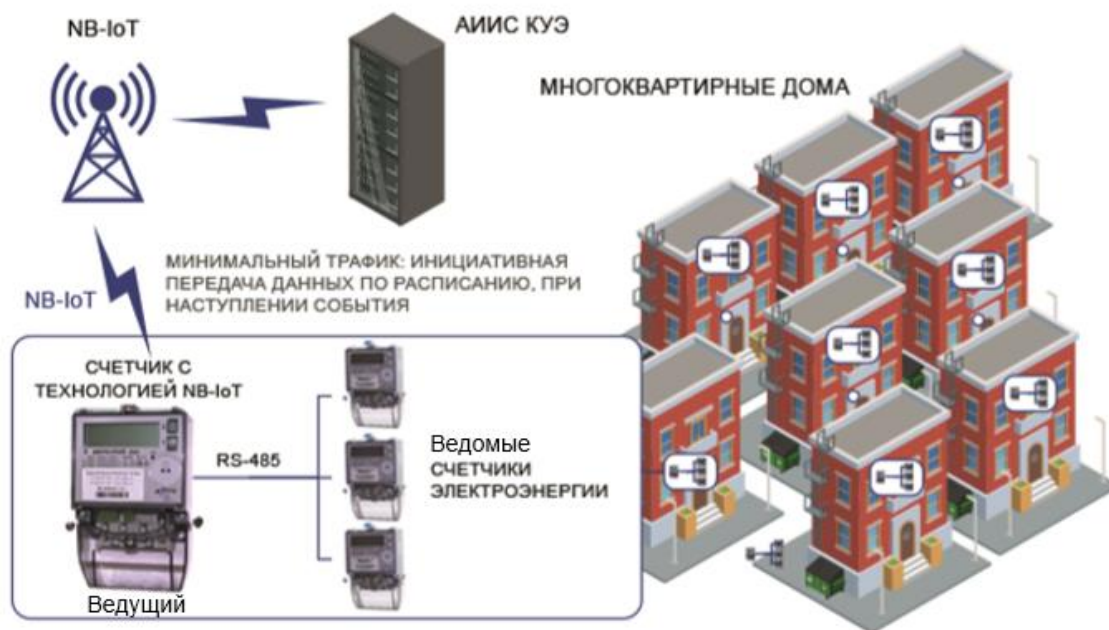
Рисунок 3.2 – Схема работы счетчика NB-IoT в составе АИИС КУЭ
