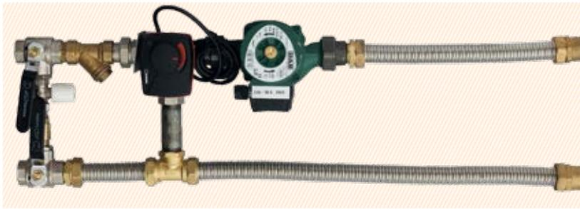
Смесительные узлы ONX применяются для регулирования производительности водяных воздухонагревателей посредством изменения температуры подаваемого теплоносителя. Изготавливаются прямой или обратной конфигурации. Прямая конфигурация применяется при температуре входящего теплоносителя до +110°C, обратная – при температуре входящего теплоносителя до +170°C.
