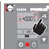
Přijmutí hodnoty  $0.00\%$  tlačítkem nebo nastavení hodnoty, např.  $+5\%$  pro osu X, pomocí komfortních funkcí tlačítek
