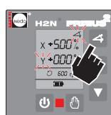
Přijmout hodnoty 0.00 % tlačítkem □ nebo nastavení hodnoty, např. +8 % pro osu Y, tlačítka ▲ ▼ komfortních funkcí.
