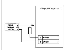
Rн – сопротивление нагрузки токового выхода до 5000м
