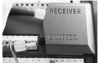
Fig. 4 : connexion du SMA au transmetteur M800 « Récepteur/Émetteur ».
