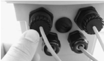
Abb. 3: Dichtungen werden durch M25 x 1,5-Kabelverschraubungen geführt.
