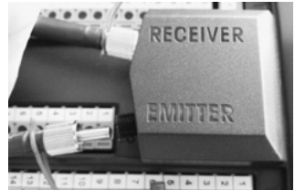
Abb. 4: SMA-Verbindung zum «Receiver/Emitter» des Transmitters M800.
