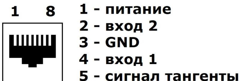
Описание контактов разъема для подключения радиостанции.
