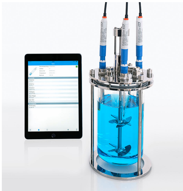
2 Пример использования в ферментере. Управление осуществляется с планшета.
