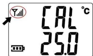
4. В процессе калибровки на дисплее будет отображаться индикатор антенны.
