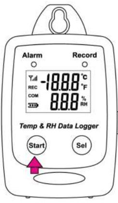
1. Нажмите однократно кнопку **Start** для запуска процесса регистрации температуры и относительной влажности воздуха в память прибора.
