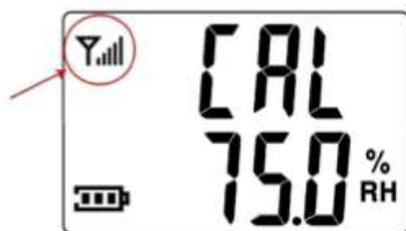
4. В процессе калибровки на дисплее будет отображаться индикатор антенны. Процесс калибровки займет около 45 минут после нажатия кнопки **Start**.
