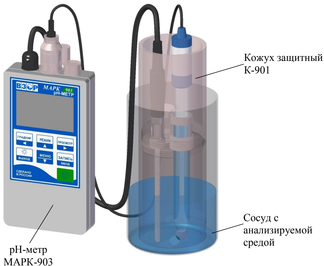
Рисунок 2.16 – Пример расположения комбинированного электрода и датчика температуры при проведении измерений с использованием кожуха защитного К-901
