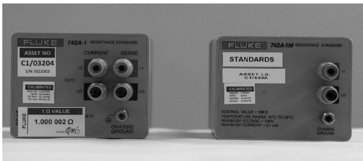
Рисунок 1 - Внешний вид резисторов прецизионных Слева Fluke 742A-1, номинальное значение 1 Ом, подключается по четырехпроводной схеме. Справа - Fluke 742A-1M, номинальное значение 1 МОм, подключается по двухпроводной схеме.
