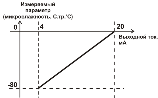
Рисунок 5.3 Линейный выход 4...20мА по диапазону влажности -80...0 °С по точке росы
