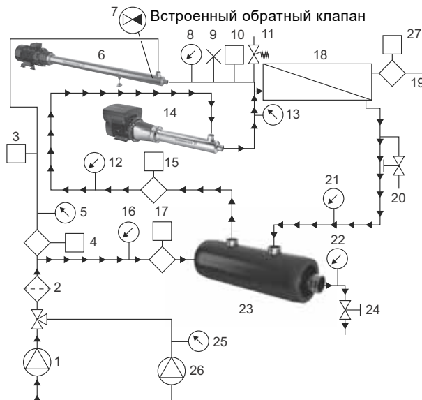
Рис. 23 Давление и расход системы, BMS hr
