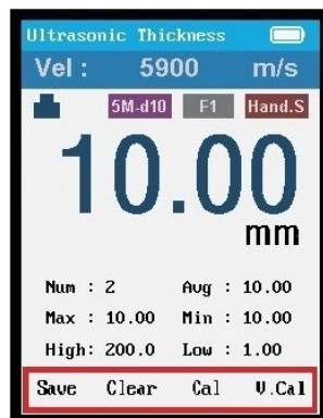
Для проведения калибровки измерения толщины стали по встроенной пластине выберите параметр (Cal) внизу экрана и нажмите «OK». Далее нанесите небольшое количество контактного геля на датчик прибора и приложите его к калибровочной пластине толщиной 4мм, находящейся в нижней части корпуса. При достаточном контакте процесс калибровки начнется автоматически, и завершится по окончании пяти циклов, после чего прибор перейдет в основной режим измерения. После калибровки
