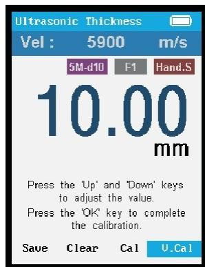
При измерении толщины закругленных поверхностей, в частности труб, важно соблюдать следующие условия: размещать датчик строго перпендикулярно плоскости и продольной оси (в противном случае показания могут быть сильно завышенны); проводить измерение несколько раз с различным положением датчика (наиболее точным значением будет наименьшее из полученных).
