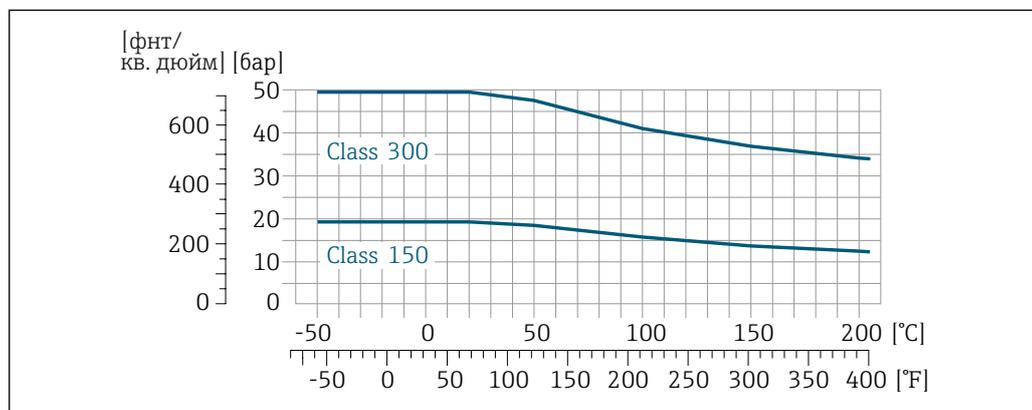
31 С материалом фланца 1.4301 (304); смачиваемые части: цирконий 702, тантал
