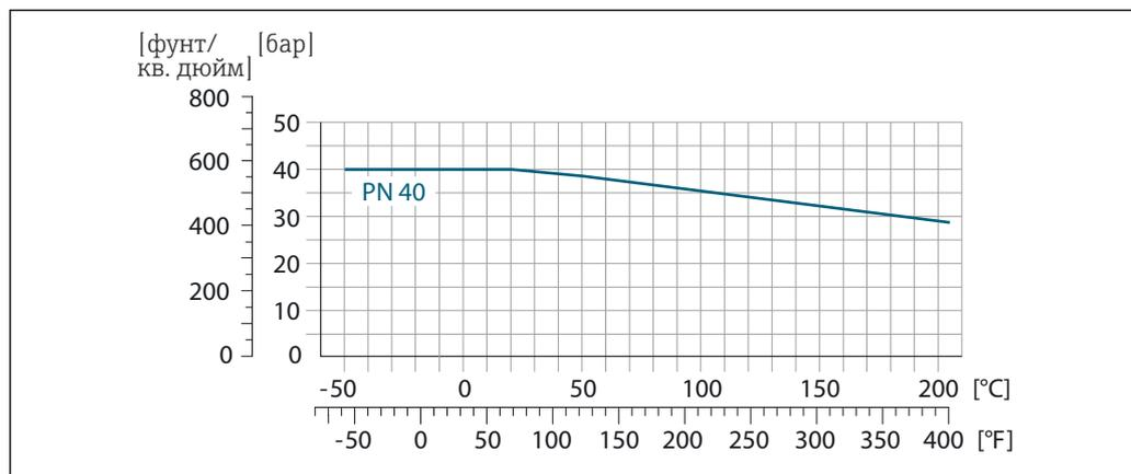
30 С материалом фланца 1.4301 (304); смачиваемые части: цирконий 702, тантал
