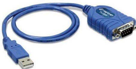
Адаптер интерфейса конвертор USB / последовательный порт TU-S9
