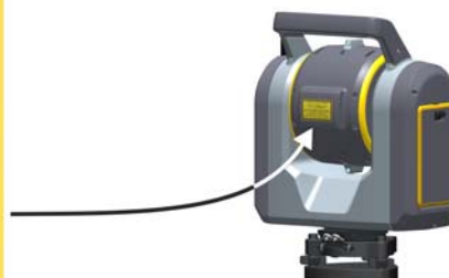
Рисунок 1.2 Расположение Этикетки с предупреждением о лазерной опасности на инструменте
