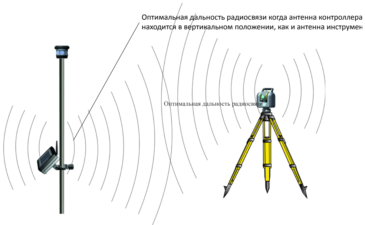
Рисунок 5.13 Оптимальная дальность радиосвязи, если антенна контроллера находится в вертикальном положении, как и антенна инструмента
