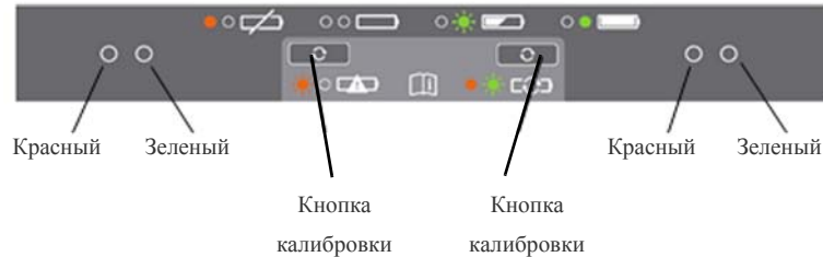
Рисунок 3.5 Панель управления зарядного устройства с двумя отсеками
