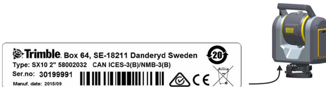
Рисунок 2.5 Расположение идентифицирующей этикетки на инструменте
